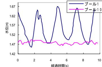
Fig.2 魚道の水面の変動
