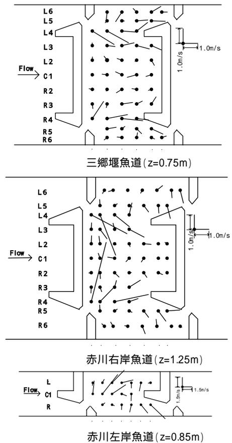
Fig.4 平面の流速分布
