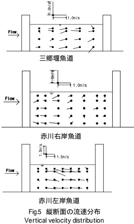
Fig.5 縦断面の流速分布
