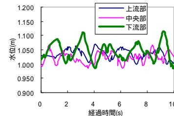
Fig.7 プール内の水面の変動
