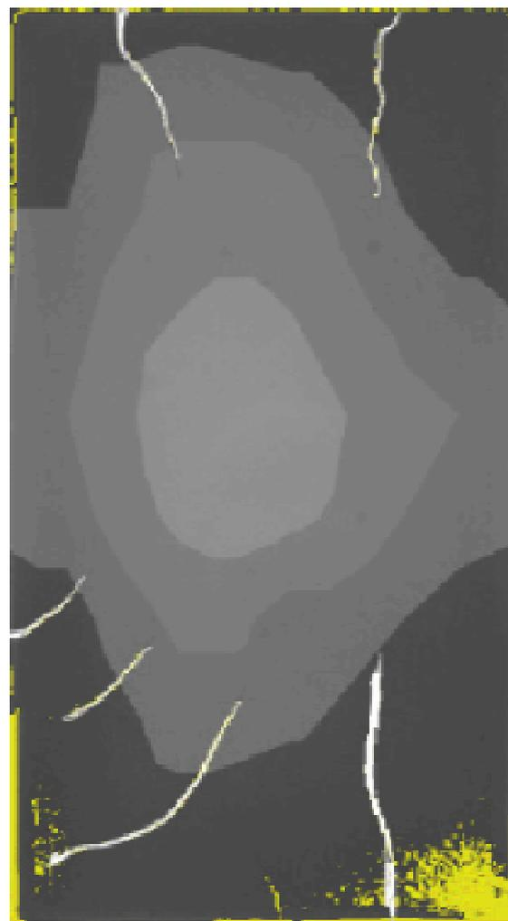
Fig.3 固相濃度等値線と亀裂発達方向の関係
