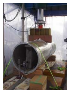
図 2. 曲げ試験 [Outline of Bending Test]
