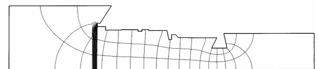
Fig.4 フローネット(副堤一体化, 本止水壁のみ考慮)
