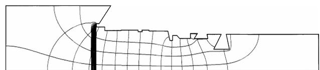
Fig.3 フローネット(本止水壁のみ考慮)
