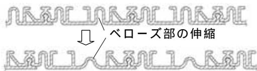
図 - 6 曲線部用プロファイル断面と伸縮機構
