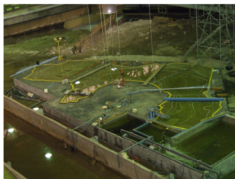
写真 1 水理模型実験の状況
