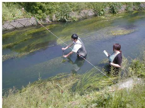
図一 1 流速観測状況 (玄手川)
