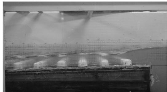
写真 1 流量 35 l/s の場合の流況例
