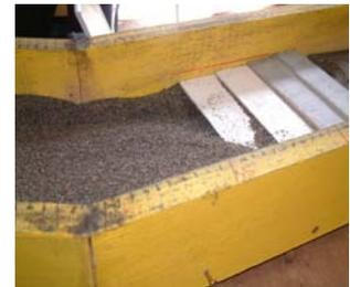
(b) 直角堰+2段式護床工
