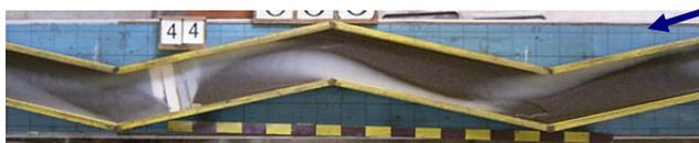
図-3 蛇行水路と堰③護床工付の配置
