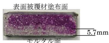
Fig.2 中性化深さ試験の結果 (B 工法, 1,000hr)
