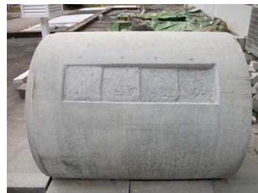
(a) RC 管の模擬欠陥の状況
