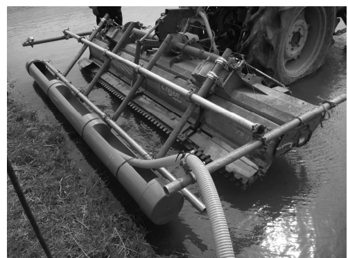
Fig.2 集水樋および吸引ホース設置状況 Catchment gutter and suck hose
