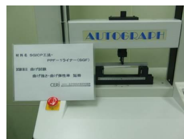
Pic.2 曲げ試験状況 Bending test
