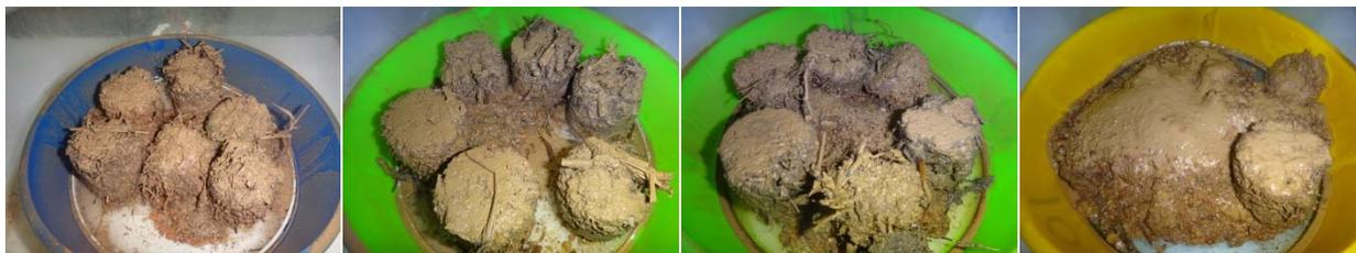
写真 1. 崩壊度試験後の供試体 Sample after slaking test (A, B, C, N from the left)
