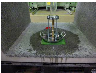
Fig. 4 透水性確認試験の状況
