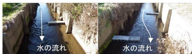
図 4 操作実験におけるコンクリートブロックの設置 (左: 区間 E, 右: 区間 F) (Experimental install of concrete blocks)
