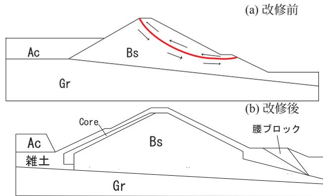
Fig.1 解析対象ため池の断面
