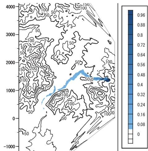
Fig.6 破堤による浸水域と最大浸水深 (m)
