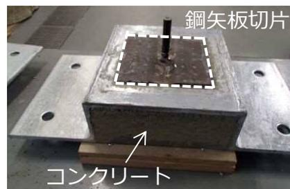
Photo 4 付着試験供試体
