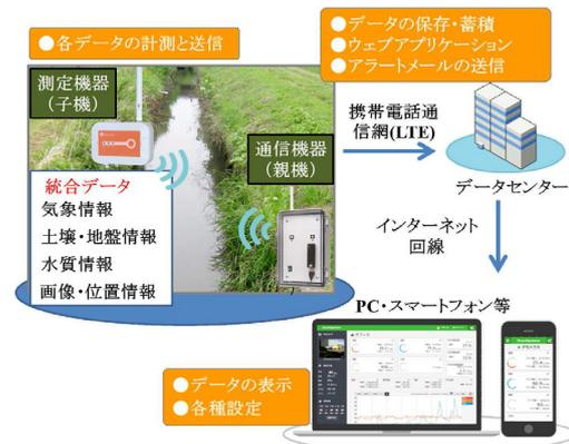
Fig.1 IoT システムのイメージ
