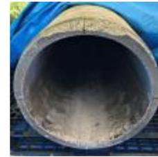
図-4 経年管の正面図（挿口側）
