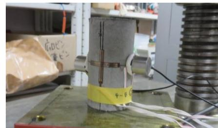
図2 AEセンサを設置した供試体
