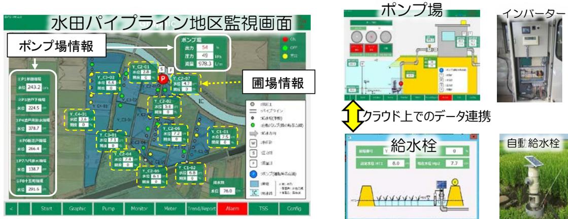
図2 システムを低平地水田パイプライン灌漑地区に適用した状況
