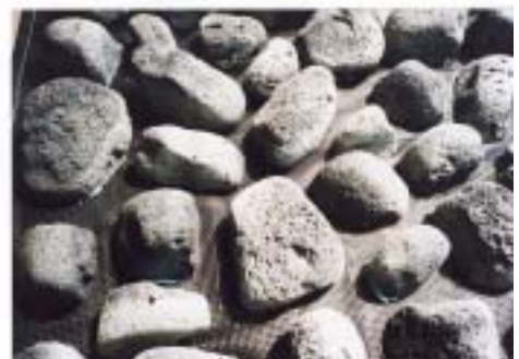
写真-3 人工石を用いた護岸材料 Revetment material using the artificial stone
