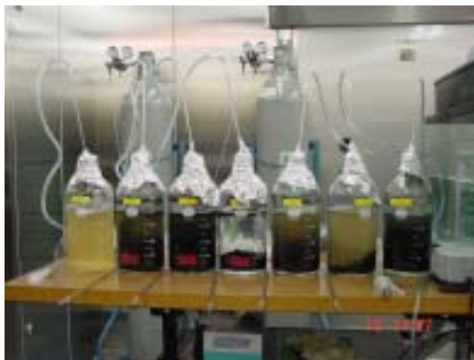
Photo 1 再資源炭の水質浄化実験
