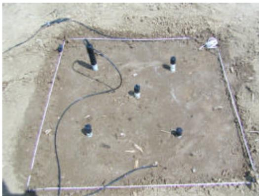
写真-1 試験区と計器の埋設
