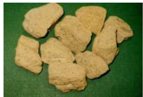
写真-1 吸水性の発泡廃ガラス材の形状 (絶乾比重0.4)
