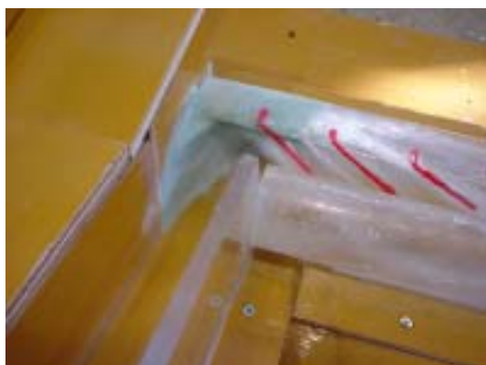
写真-2 90°屈曲部での流況 (2.86m³/s)
