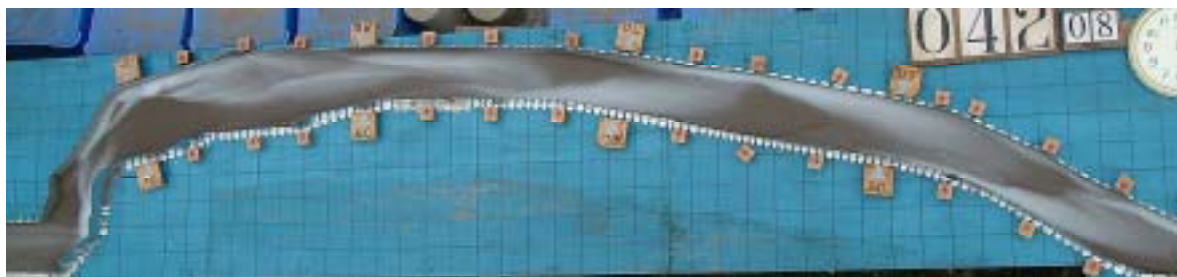
図 - 3 羽越荒川（新潟県）1/1000 縮尺の模型水路において再現された砂礫堆と水流蛇行（水路床勾配：1/90，流量：0.5L/s，水路床粒子：平均粒径 0.8mm，比重 1.93）
