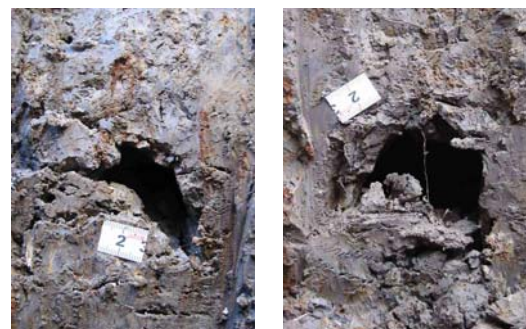
写真 1 暗渠孔空隙部の状況 ※左 1 作 30cm 区 右 1 作対照区
