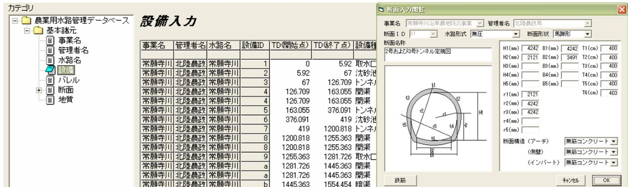
図-1 農業用水路変状データベースシステムの階層構造および諸元データ入力例
