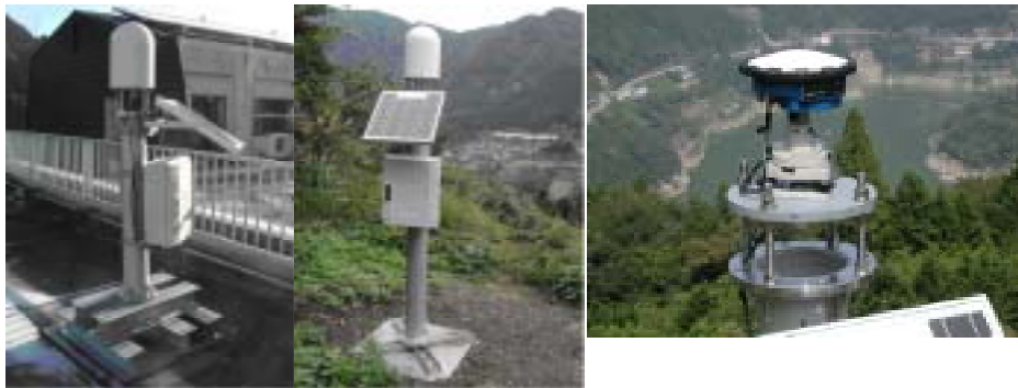
図1 観測点構造 左：基準点、 中：移動点、 右：レドーム内部
