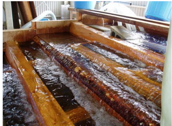
図-2 丸太を1/4に切った材木を設置した場合の流れの様子
