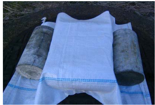
Photo 養生方法の写真(屋外)
