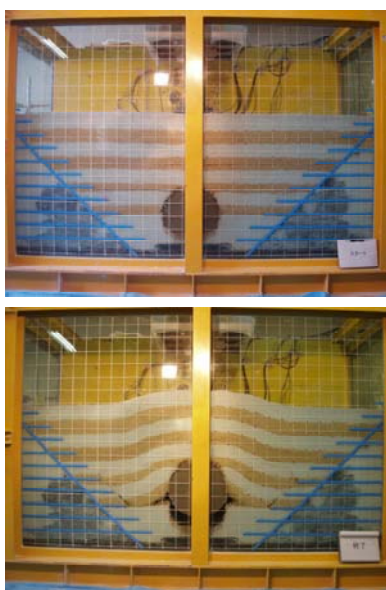
写真1 地盤の変形(全巻・繰返し) (上:試験開始前 下:終了後) Deformed ground
