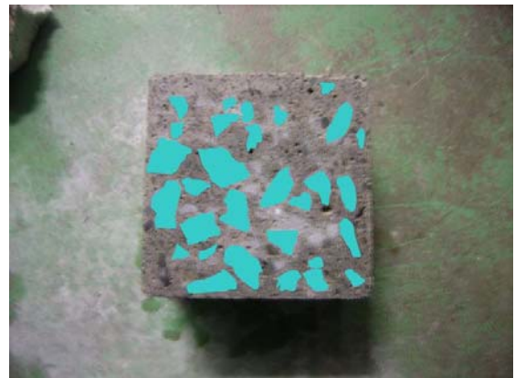
写真-2 画像処理後の断面 Cross section of specimen after image-processing
