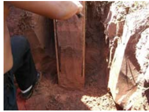
写真 2 断面の整形 Arrangement
