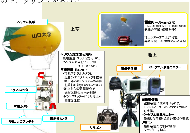
図1 気球空撮システムの概要
