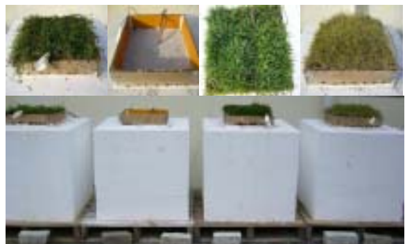
写真-1 供試体の温度計測状況
