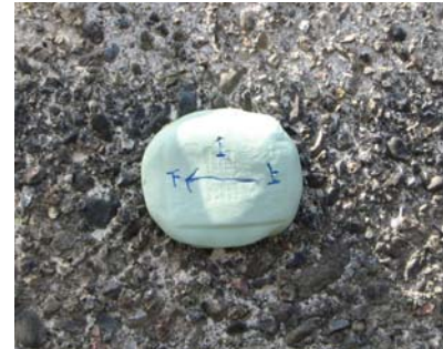
図1 表面形状写し取り状況 Easy Method of Canal Surface
