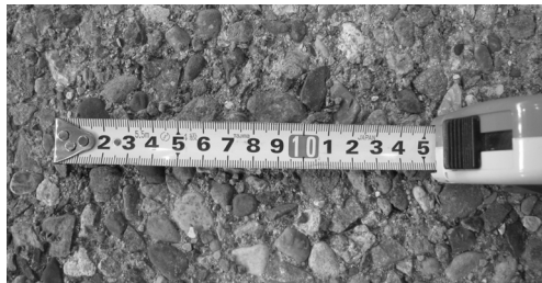
図2 実験に用いた模擬摩耗板
