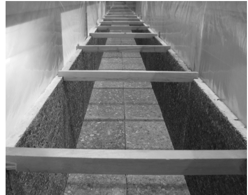
図1 模擬摩耗板の水路への設置状況
