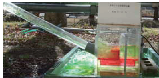
写真5 合流柵の改良案に対する流況
