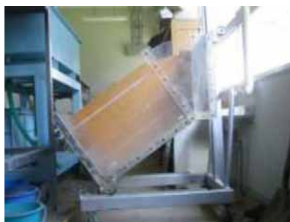
写真2 模型斜面装置（側面から撮影） 手前側にアクリル板・奥側に木製板が確認される
