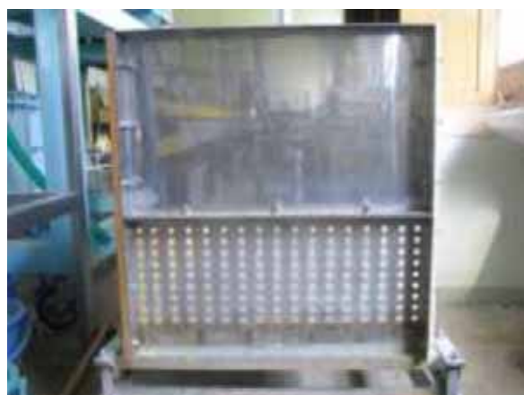
写真1 模型斜面装置（正面から撮影） ステンレス製の土砂留め兼ドレーン孔が確認される
