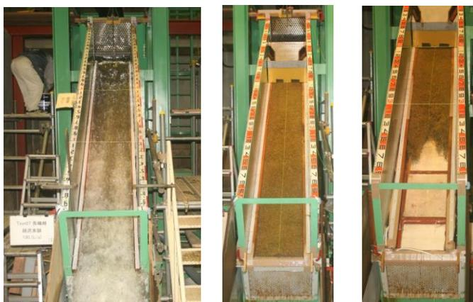
(a)越流実験の状況 (b)堤体表面被覆工法 (c)植生のみ
