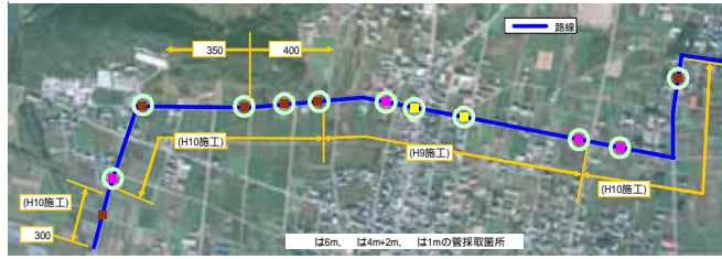
図-1 FRPM管掘り出し箇所
