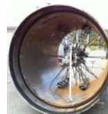
写真2 内径測定システム Pct. 2 Inner diameter measurement system
