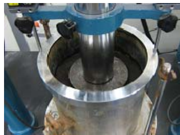
写真-1 繰返し載荷 CBR 試験状況
