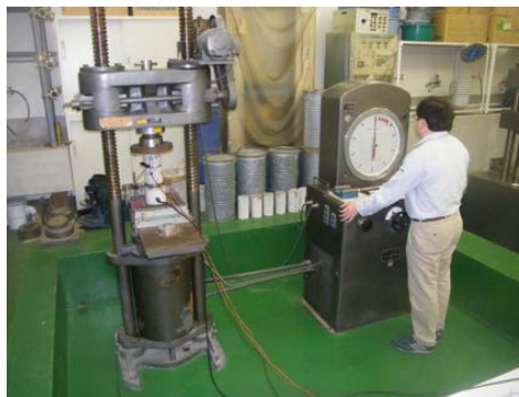
写真 1 圧縮強度試験及び AE 計測状況
