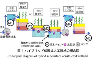
農地と畜産農家からの排水が流入する道路側溝の排水と、ビジターセンター敷地内の駐車場の雨水排水 (2010年10月以降)である。道路側溝の排水はポンプアップして最初の自動サイホンに流入させ、駐車場 の雨水排水は3段目の横型Bに流入させている。縦型Aと縦型Bの前には自動サイホンを設置し、汚水を 間欠的に濾床表面に供給するようにして縦型の好気的な条件が保たれている。
