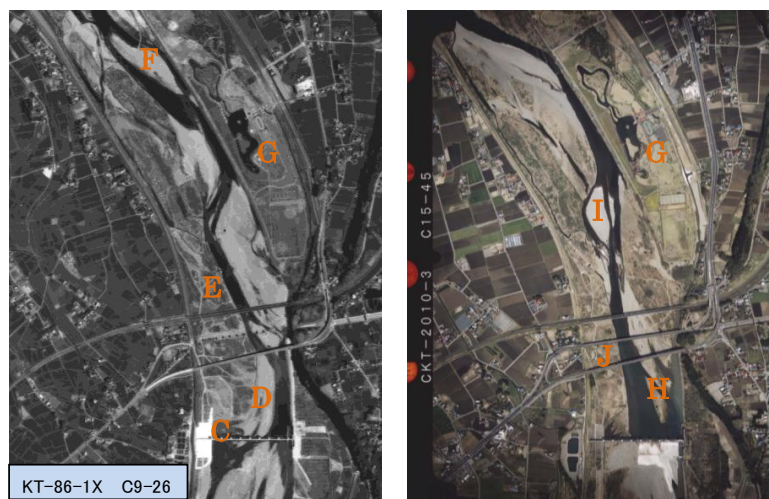
図-3 岡本頭首工上流区間のみお筋変化 (1986 年→2010 年)
