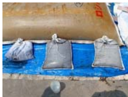
写真-1 脱水状況 (左から一般土のう, 一般土壌用エコチューブ, 汚染土壌用エコチューブ)
